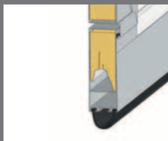
Standardní práh výška prahu 140+20 mm
