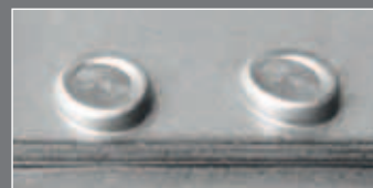
Tox moderní způsob spojování
